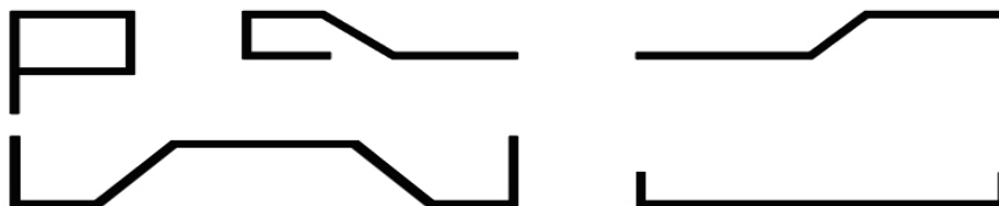
Рис. 5 Формы изгиба арматуры
